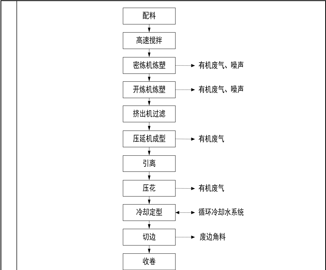
图 2.6-1 压延工艺流程及产污环节示意图
